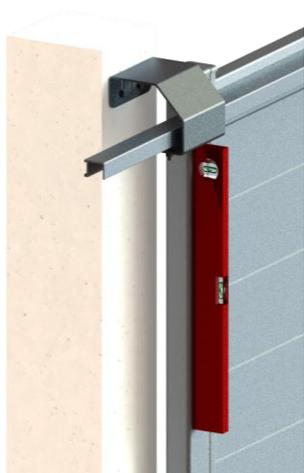
A l'aide d'un niveau à bulle, contrôlez l'aplomb du portail. Au besoin, ajustez l'aplomb en jouant sur la position des roulettes de guidage
