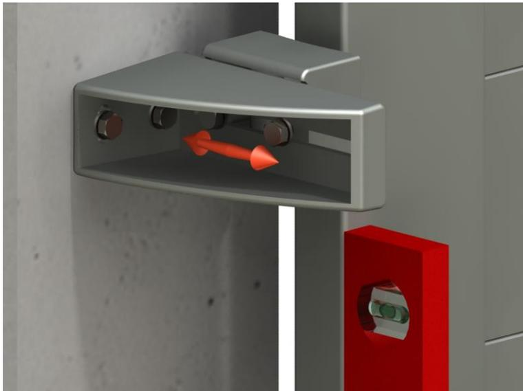
A l'aide d'un niveau à bulle, contrôlez l'aplomb du portail. Au besoin, ajustez l'aplomb en jouant sur la position du vé de réception
