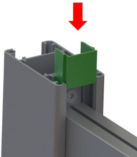
Etape 10: Mettez en place le profil U finition (coupé à la longueur de l'entre poteaux à l'aide d'une scie à métaux) et le coller avec des points silicone au dessus du profil Claustra
