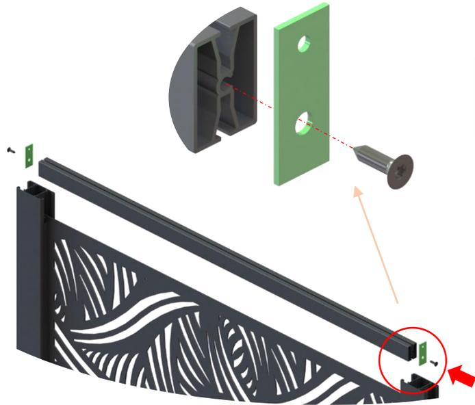
**Etape 6:** Faites glisser le profil claustra jusqu'à être en appui sur les closoirs tôle
