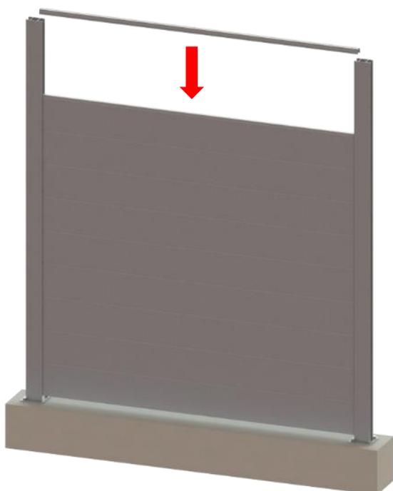
**Etape 3:** Faites glisser les deux closoirs tôle jusqu'au profil jonc
