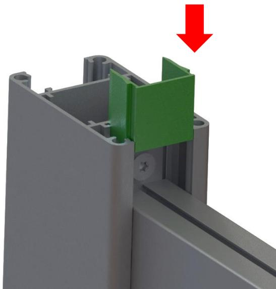
Etape 9: Mettez en place le profil U finition (coupé à la longueur de l'entre poteaux à l'aide d'une scie à métaux) et le coller avec des points silicone au dessus du profil Claustra
