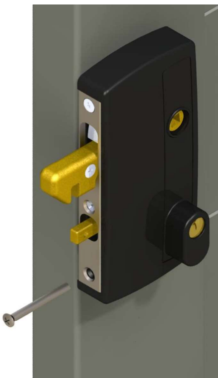
Effectuez le serrage du cylindre à l'aide de la vis inox tête fraisée M5x70
